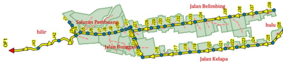
Gambar 5. Tata letak model simulasi sistem drainase lokasi studi
